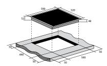
Размеры прибора (В хШхГ): 52x590x520 мм Вес нетто: 8.8 кг
