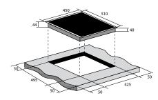
Размеры прибора (В хШхГ): 44x450x510 мм
