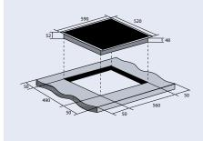
Размеры прибора (В хШхГ): 52x590x520 мм
